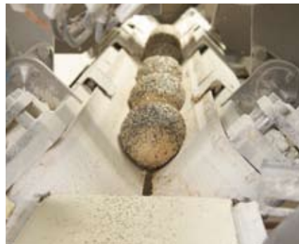
Debido a la diferencia de velocidades la masa de pan adquiere una forma esférica.
