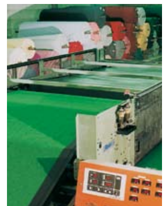
Superposición de capas de velo en la industria del Nonwoven. La alta velocidad de producción y la aceleración de masas con conducción directa del velo entre las bandas exigen un máximo a las bandas de procesamiento empleadas.
