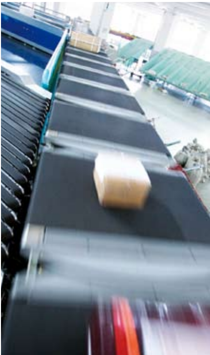
Equipo de selección transversal en un centro de distribución. La alta aceleración exige valores de rozamiento extremadamente favorables de la superficie de banda.
