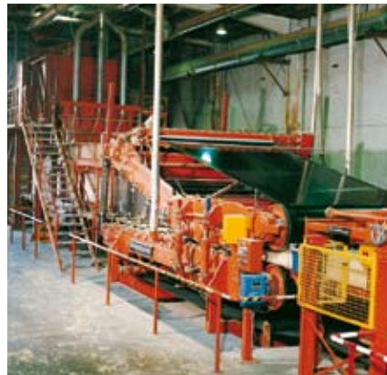
Banda de prensa previa en la producción de planchas de aglomerado. Durante su transporte a la prensa, la masa de virutas queda precompactada.
